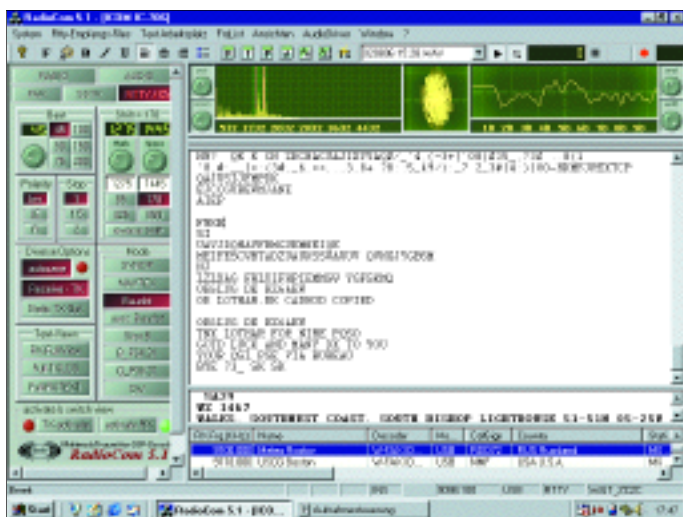
Bild 4: Die Beiden „Nadeln“ eines RTTY-Signals sollten sich in der Scopedarstellung unter den roten Linien befinden.
